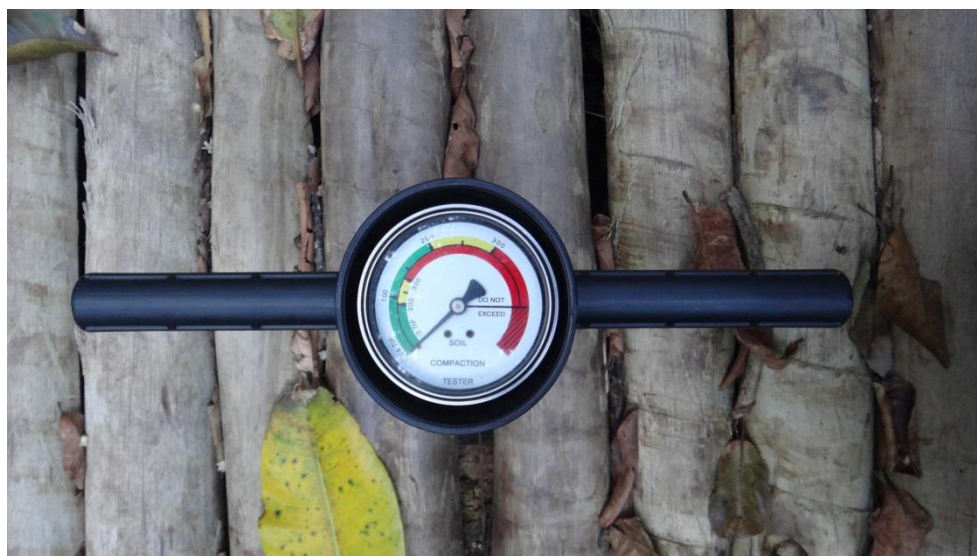
Figura 5: Faixa de valores de compactação oferecida pelo penetrômetro.(Foto: Douglas de Souza Pimentel, 2013.)
