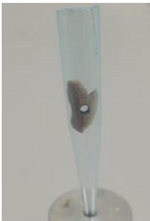
**Figura 12:** Amostra de dente de tubarão-tigre (*G. cuvier*) colocado em pipeta plástica para medidas na linha de luz.
