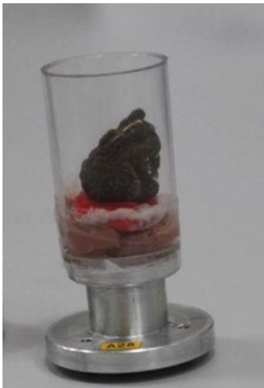
**Figura 11:** Amostra de otólito de corvina (*M. furnieri*) colocado em um cilindro de plástico para medidas na linha de luz.
